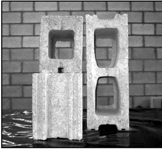
Figura 2. Bloques de hormigón hueco
